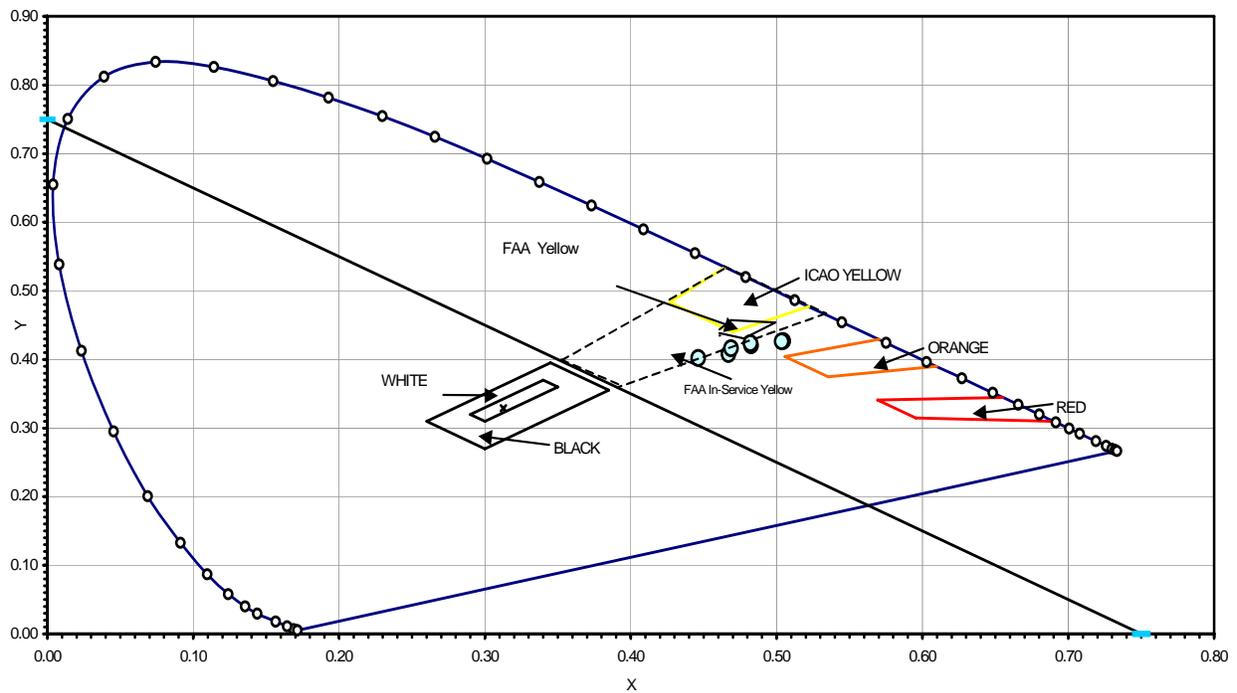
FIGURE A-4. COLOR READINGS (YELLOW) TYPE III BEADS ON ASPHALT
